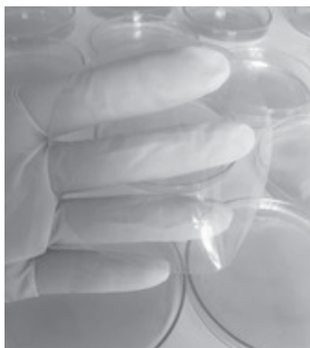
Figura 4. Biomembrana de Látex Natural ( Hevea brasiliensis ) confeccionada em laboratório do Instituto de Química da Universidade de Brasília (UnB). Fonte: O autor (2020).
